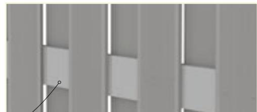
Querriegel aus pulverbeschichtetem Aluminium
